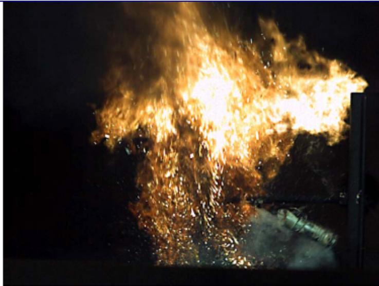
FIGURE 9. HIGH-SPEED VIDEO CAPTURE OF EXPLODING CELL
